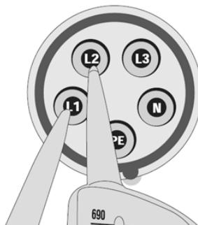
Přiložte oba měřící hroty k měřenému objektu (zastrčte je do zdířek síťové trojfázové zásuvky, přiložte je ke kontaktům elektrických přístrojů, například ke kontaktům třífázového motoru atd.).
