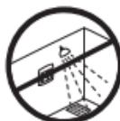
Neumistujte termostat do vlhké místnosti. Termostat musí být umístěn mimo zónu 2. Umístěte ho do vedlejší místnosti a použijte pouze podlahový snímač. Termostat vždy umístěte ve shodě s platnými místními předpisy o krytí.
