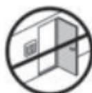
Jestliže používáte regulaci teploty podlahy i teploty v místnosti, nebo pouze regulaci teploty v místnosti, nainstalujte termostat ve vzdálenosti nejméně 50 cm od oken a dveří, kvůli průvanu.
